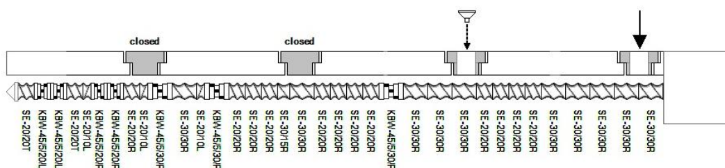
Joonis 4. Kruvi konfiguratsioon madala veesisaldusega ekstrudeerimisel. Vasakpoolne nool näitab veetoite, parempoolne pulbritoite asukohta kruvi suhtes. Materjal voolab vasakule.
