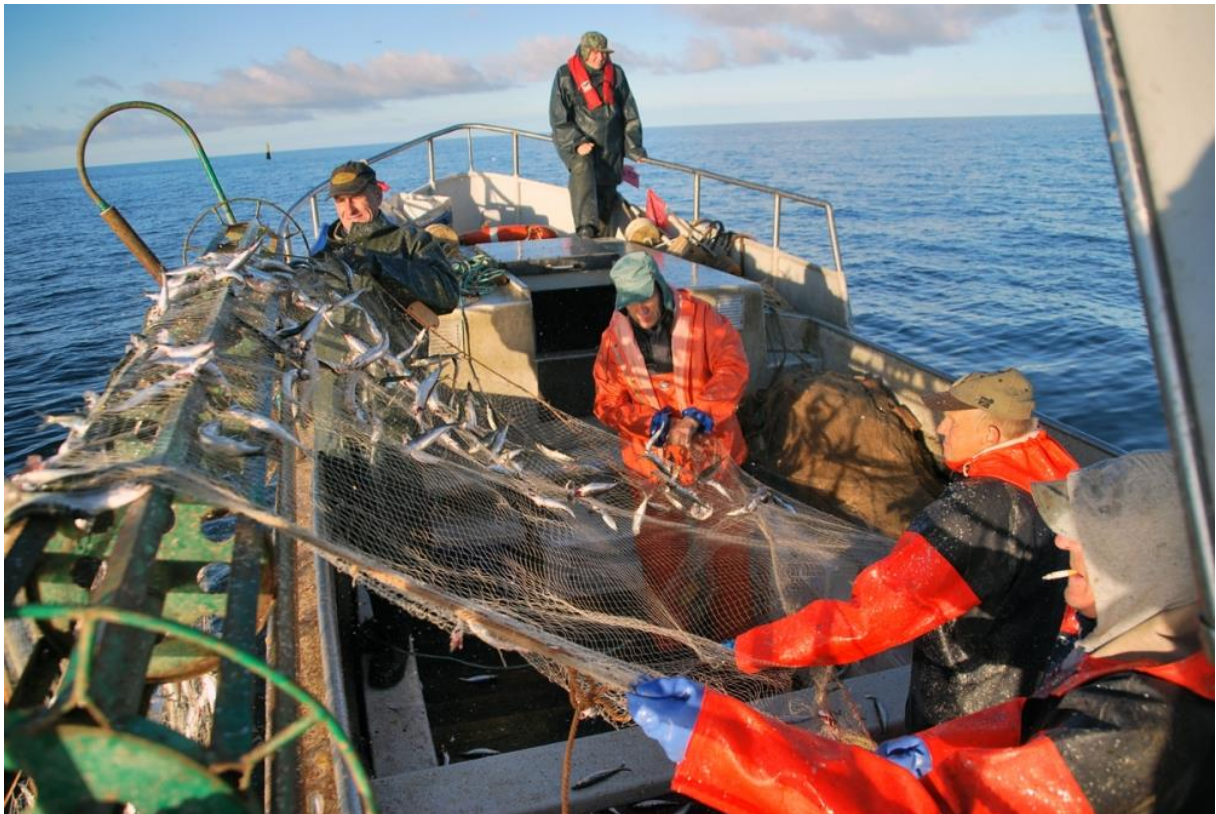
PILT 10. Võrgurulli kasutamine lihtsustab märkimisväärselt sügisträime püüki ja teeb raske, kala täis oleva võrgu paati sikutamise märksa lihtsamaks. Paraku aga ei peeta sageli sellise investeeringu tegemist sügisträime püüdjate seas otstarbekaks, kuna sügisträimele turgu ei ole.
