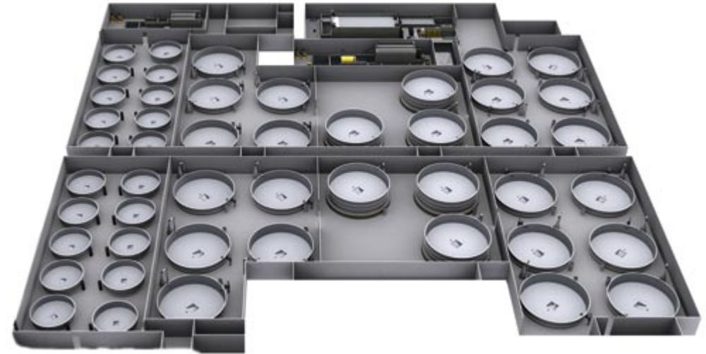
Joonis 8.5. Kolmemõõtmeline joonis suurest kasvandusest, kus iga 15-meetrise läbimõõduga basseini mahutab üle 500 m 3 vett. Allikas: AKVA kontsern.
