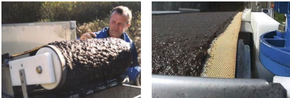
Joonis 6.2. Hydrotechi lintfilter muda veetustamiseks. Allikas: Hydrotech.
